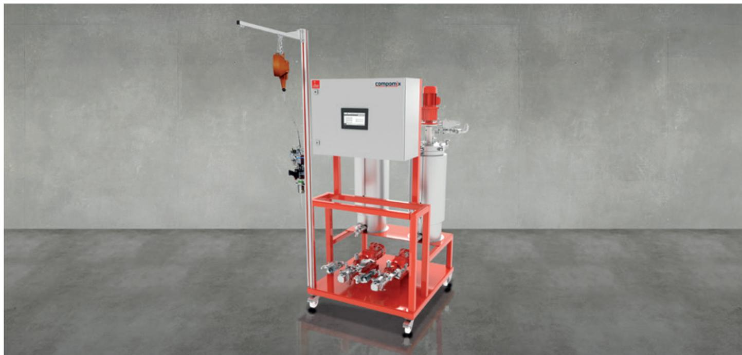
Il compomix FI è stato costruito appositamente per l'impregnazione dei materiali fibrosi nelle applicazioni di infusione sottovuoto, resin transfer moulding (RTM), pultrusione e filament winding. Dosa e miscela i materiali a due componenti, con i quali impregnare quindi le fibre di vetro, aramide o carbonio (fibre impregnation / FI). A seconda dell'applicazione, con il sistema di dosaggio è possibile riempire
