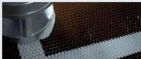
à développer coredis qui assure un remplissage optimal, répétable, des alvéoles des panneaux « nid d'abeilles » et ce, tout en préservant la sécurité du personnel de production. Son intégration dans des cellules robotisées permet, pour la première fois, des opérations de « Potting » en série, de panneaux « nid d'abeilles » destinés à la réalisation de sous-ensembles d'intérieurs pour avion.
