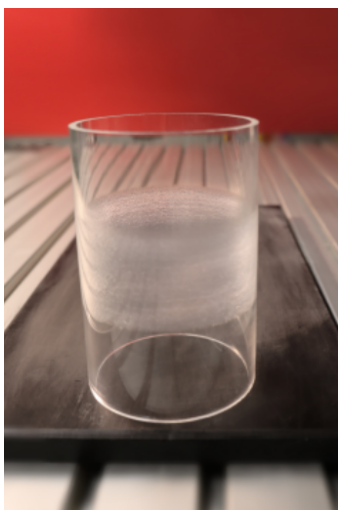
360° Fettauftrag mit dem Rotationsapplikator von DOPAG
