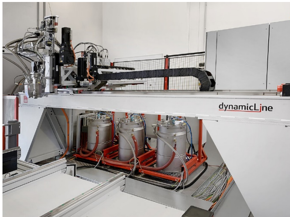
Die drei Komponenten werden über Drucktanks gefördert, links der dynamische Mischkopf für den Materialaustrag
